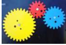
شكل (٤) يوضح الاحتكاك المباشر لنقل الحركة
